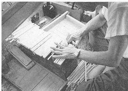
図7-2-30 竹軸の製造
